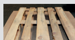
Unzulässiges, nicht dem Technischen Regelwerk der EPAL entsprechendes Bauteil, z. B. untermaßig, morsch, Baumkante
